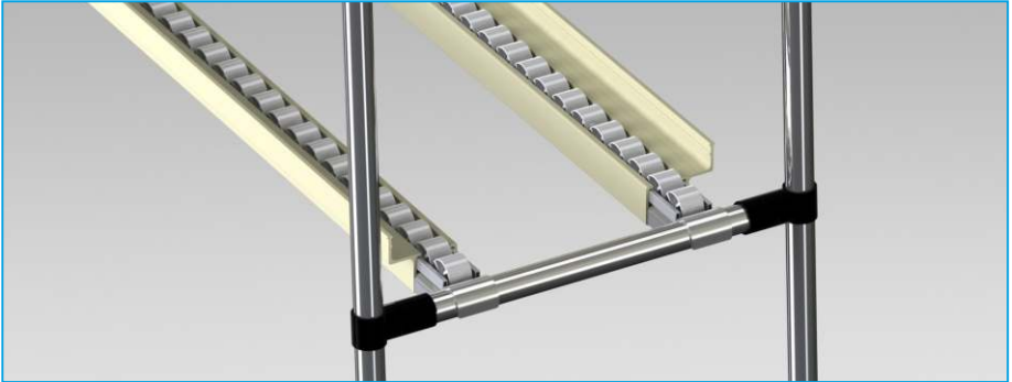
RTG-3 - Vorsicht: die Führung reicht nicht bis zum Ende der Rollenbahn
