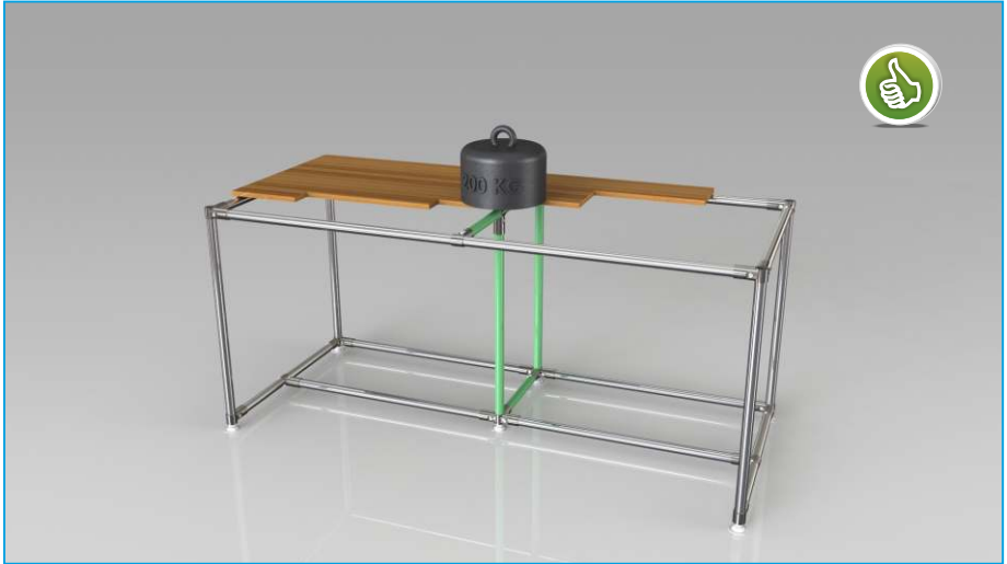
Lösung 2: Vertikale Stützstrebe
