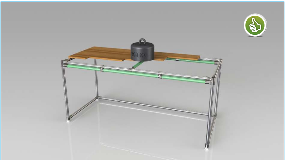
Lösung 1: Doppelrohr mit horizontaler Verstrebung
