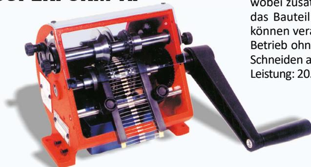
Zum Schneiden und Biegen von gegurteten, axialen Bauteilen zur Steckmontage, wobei zusätzlich die beiden Drahtenden mit einer Sicke versehen werden, damit das Bauteil senkrecht auf der Platine steht. Anschlußdrähte von 1 bis 1,4 mm können verarbeitet werden.
