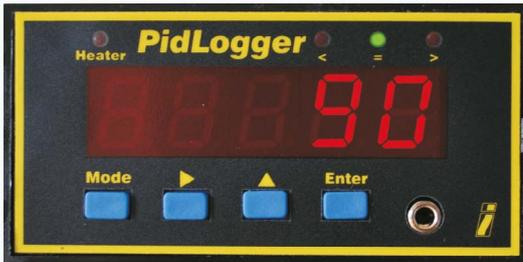
Elektronische Temperatur-Steuerung mit PID-Regelung und Multifunktions-Timer.
