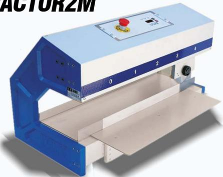
TRACTOR 2 ist ein Nutzentrenner für geritzte Platinen mit einer Schnittlänge bis zu 450 mm. Die Platine wird mit einer Ritze auf das Linearmesser gelegt. Die Trennung erfolgt mit dem runden Messer von Hand oder mit Motor. Der Abstand zwischen dem runden und dem Linearmesser ist einstellbar.
