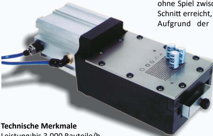
Mit der pneumatischen Schneidemaschine SUPERCUT/LN5 können die Anschlüsse von losen Radialbauteilen präzise geschnitten werden. Durch die präzise Mechanik ohne Spiel zwischen der Oberplatte und der Kobalt-Unterplatte wird ein gerader Schnitt erreicht, ohne jegliche Grate oder Verformung der Drahtoberfläche.
