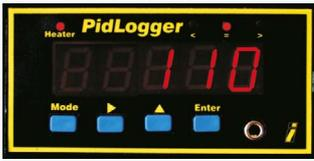
Alle unsere Öfen sind mit Datalogger ausgerüstet und erlauben die Verfolgbarkeit, das Drucken / Speichern des zeitlichen grafischen Verlaufes der Temperatur (für Sahara) und der Temperatur / Feuchte (für Sahara DRY). Für die Analyse der Daten des Dataloggers und für die Programmierung der thermischen Steuerung, wählt man die Option **8107.215** Software PidManager mit dem USB-Spezialkabel.
