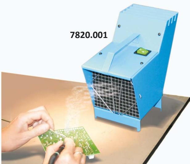
Das Absauggerät GOSMOKE bietet eine praktische und wirtschaftliche Lösung zur Entfernung der Dämpfe, die sich beim Löten bilden. Die Dämpfe werden unmittelbar vor dem Bediener abgesaugt, gefiltert und direkt nach oben abgeleitet, wo eine zusätzliche Entlüftungsanlage vorgesehen werden kann. Das modelle ist mit einem Axiallüfter und mit einem Filter, aus mit Aktivkohle imprägniertem Polyurethan, ausgerüstet. Der Filter ist alle 100 Betriebsstunden zu wechseln.
